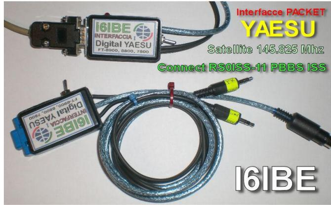
Alcuni prototipi realizzati, per la connessione della SERIALE al PC utilizzate una PROLUNGA DB9 RS232 pin to pin o cavo dritto.
